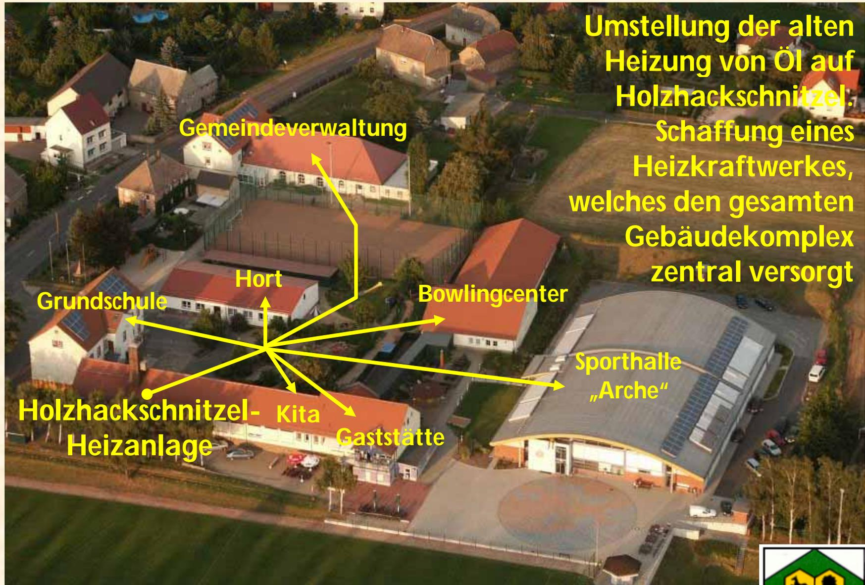
Umstellung der alten Heizung von Öl auf Holzhackschnitzel. Schaffung eines Heizkraftwerkes, welches den gesamten Gebäudekomplex zentral versorgt
