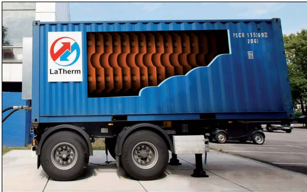
Mobiles Latentwärme-Transportsystem auf Natriumacetat-Basis (Quelle: Datenblatt LaTherm GmbH, Dortmund, www.latherm.de )
