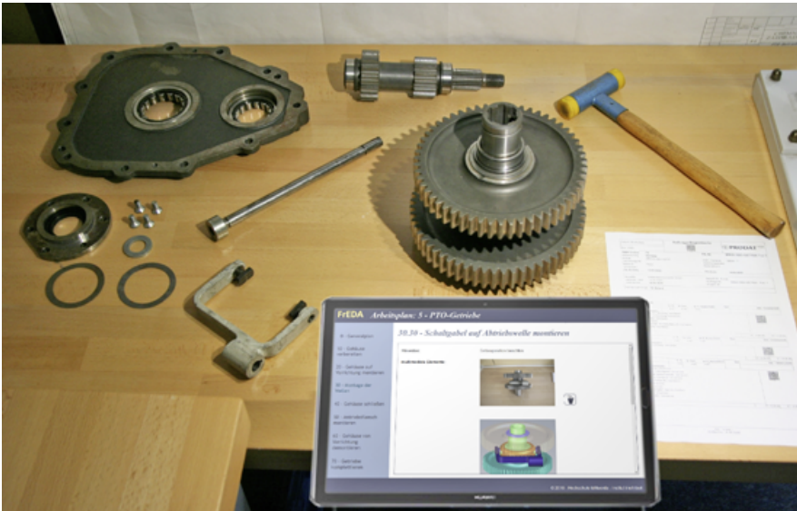
Bild 3. App Multimedialer Montageplan auf Tablet am Beispiel Getriebe (Montageschritt Schaltgabel auf Antriebswelle montieren)
